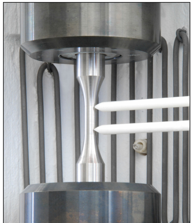
Probe mit Längenänderungsaufnehmer im Hochtemperatur-Ofen
